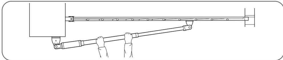
Una volta realizzati i fori, staccare la piastra di fissaggio dal motore rimuovendo la copiglia. Fissare la piastra al cancello utilizzando preferibilmente delle viti passanti.
