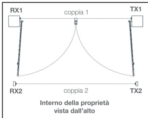
in questo caso, prima di aprire i battenti, il sistema deve verificare che il raggio infrarosso non sia interrotto, ma come impostazione predefinita le fotocellule sono testate solo in fase di chiusura.
